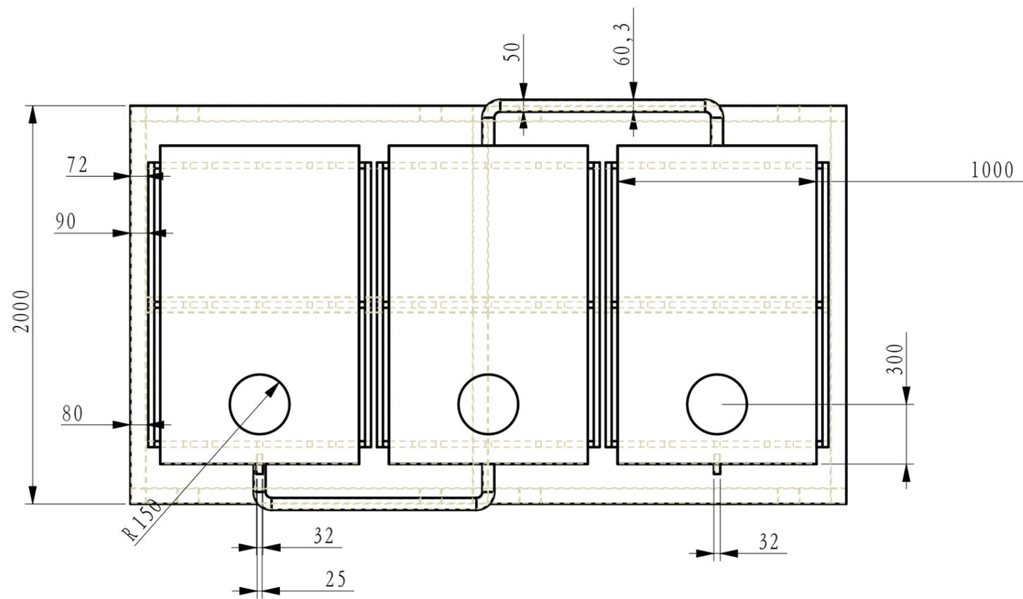
图上①为出水管，②为进水管，都是DN25的管，两头都有内螺纹。
