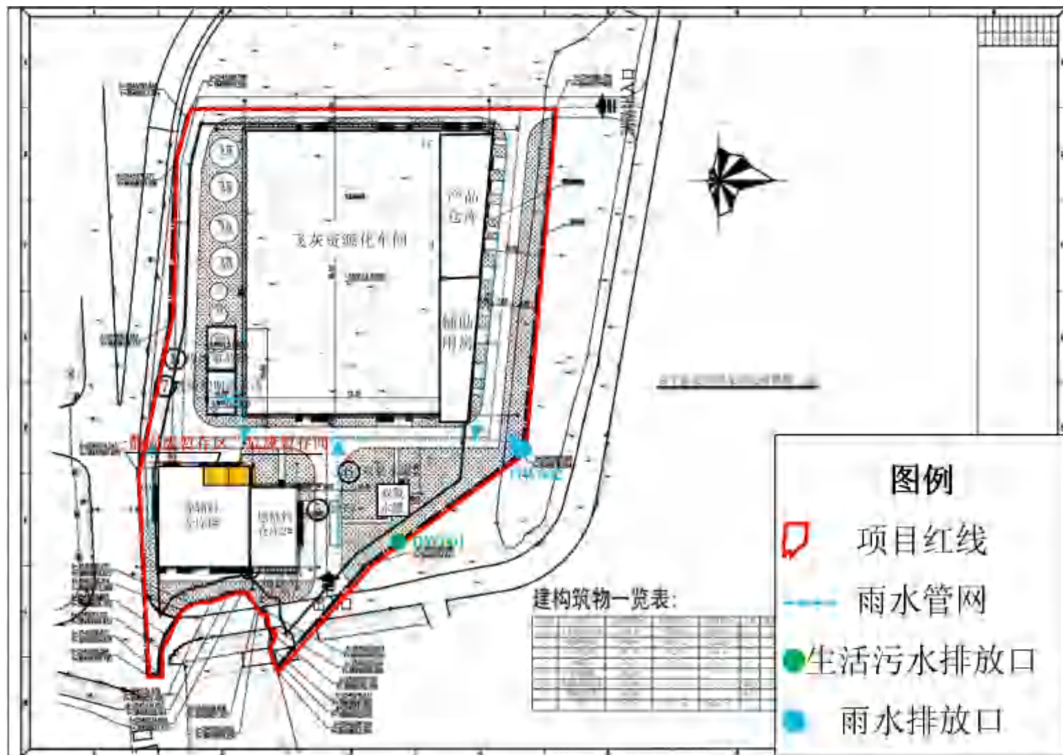
图 3.1-4 项目雨水管网图
