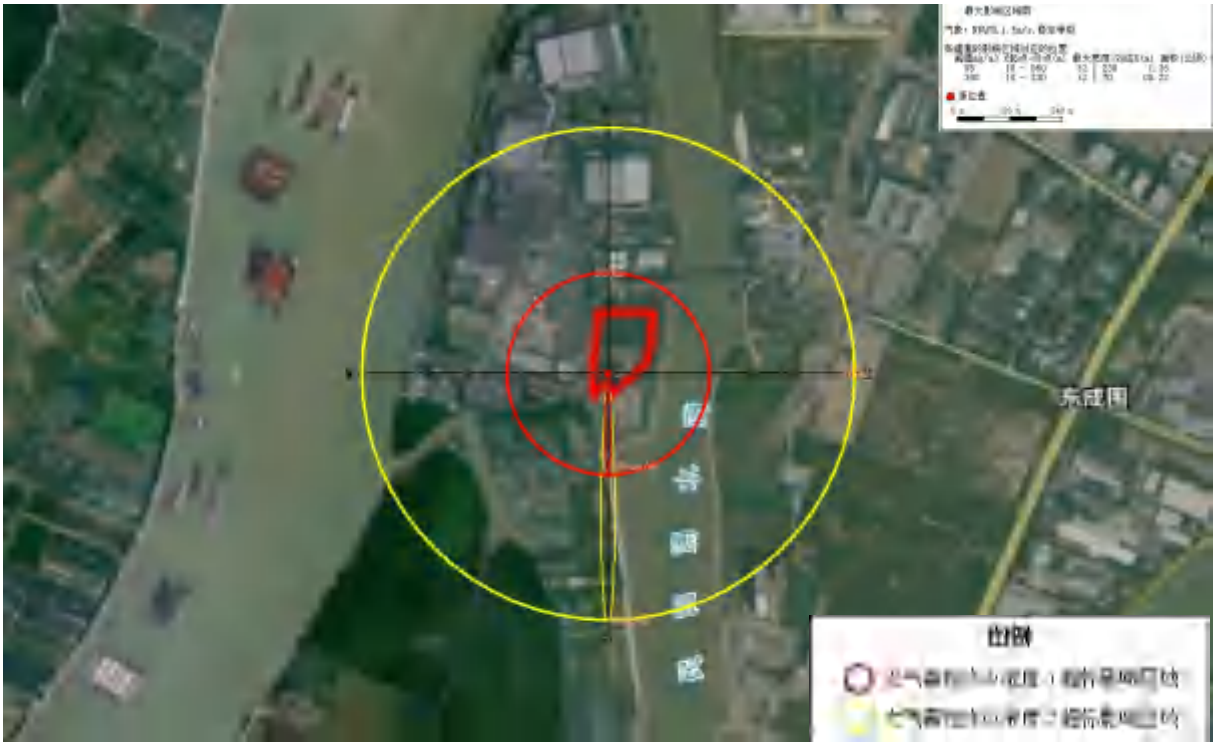
图 5.8.6-3 最不利气象条件下，CO 达到不同毒性终点浓度的最大影响范围图
