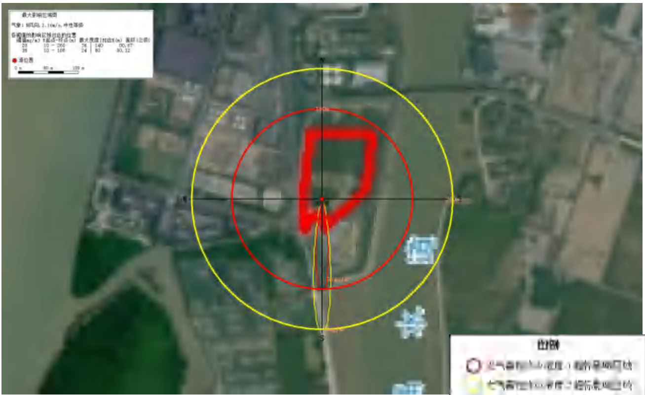
图 5.8.6-2 最常见气象条件下，氢氟酸达到不同毒性终点浓度的最大影响范围图
